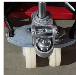
2 Ruedas direccionales con eje rotatorio.
