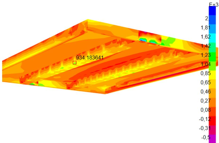
**Figura 9. Tensiones máximas en dirección 1 [kg/cm<sup>2</sup>].**
