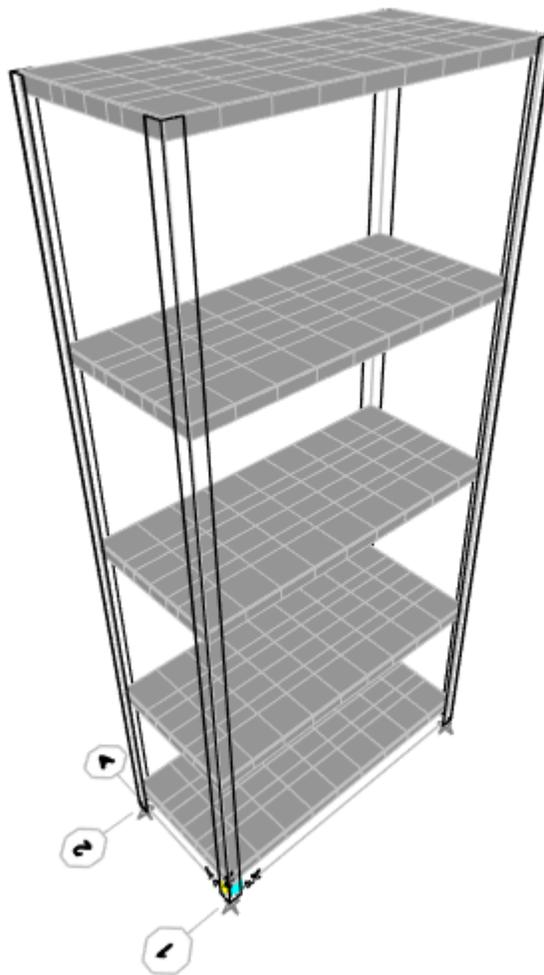
Figura 2. Vista en Perspectiva Estante – Modelo de Elemento Finitos.
