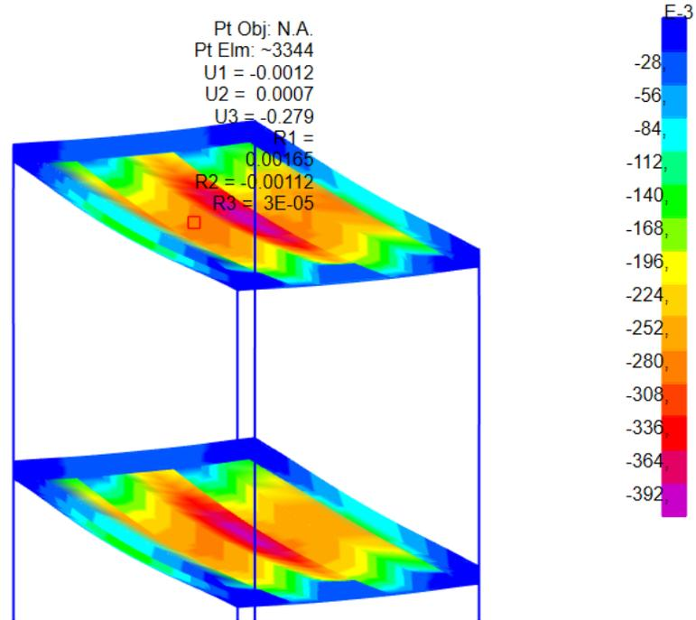
Figura 7. Deformaciones máximas en dirección 1 [cm].
