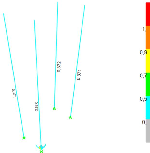
Figura 5. Factores de Utilización L40x40x2.
