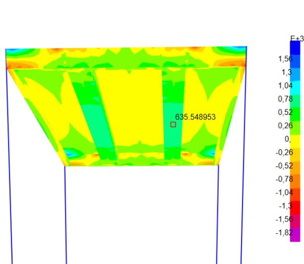
Figura 6. Tensiones máximas en dirección 1 [kg/cm<sup>2</sup>].
