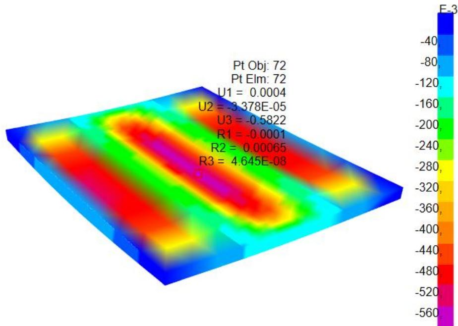
**Figura 10. Deformaciones máximas en dirección 1 [cm].**
