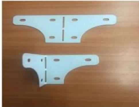
Material: Ángulo doblado 40x40 por 2mm de espesor
