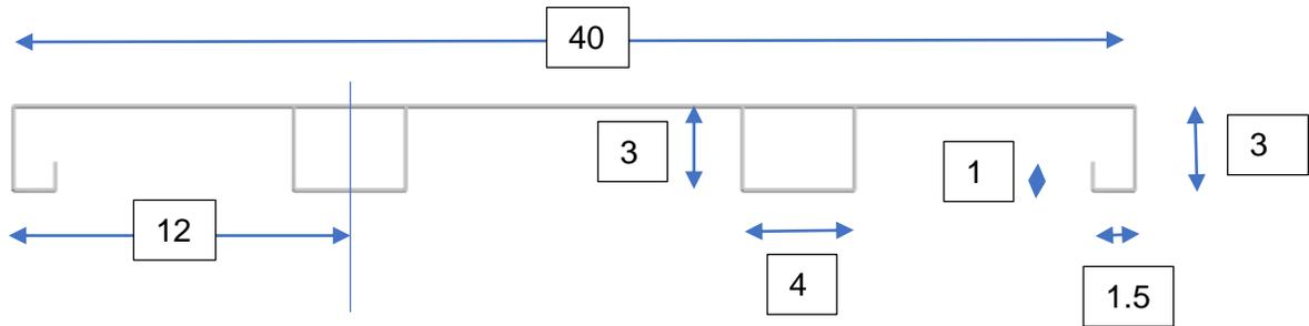
Figura 4. Sección Transversal de Diseño Bandeja 90x40 (unidades en cm).
